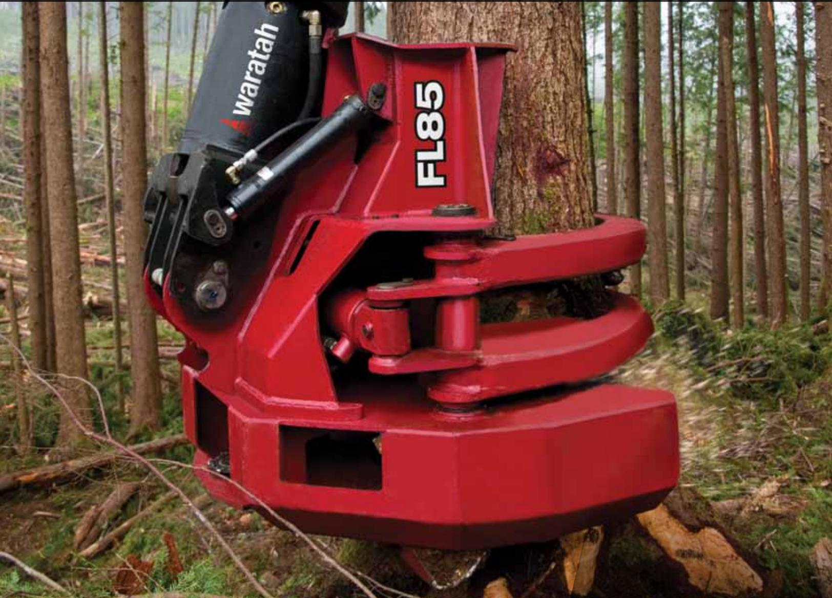
Универсальный агрегат **Waratah FL85** – это и харвестерная головка, и грейфер, и пила – все в одном. Этот хорошо продуманный высокопроизводительный агрегат предназначен для валки крупных деревьев и для работы при выборочных рубках.
