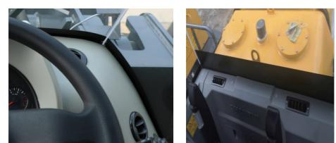
Вентиляционные отверстия в кабине теперь находятся в других местах, обеспечивая циркуляцию кабины, улучшая обогрев и охлаждение кабины.
